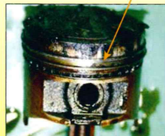
汚れたピストン
